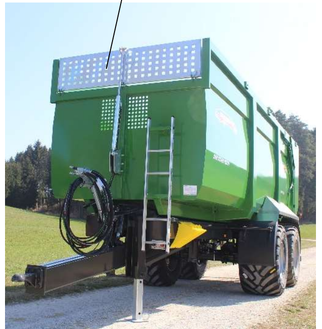
4-Blatt TL Federung (Serie b. TDM 2370 L) Niedrige Brückenhöhe u. Schwerpunkt
