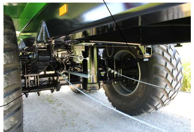
Tandemaggregat für besten Bodenausgleich (Serie)
