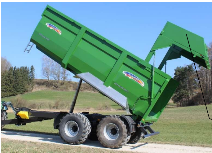
Großraumrückwand bei Muldenhöhe 2000 mm
