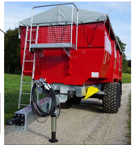
Stirnwandgitter hydraulisch abklappbar (nur bei. Muldenhöhe 2000 mm )
