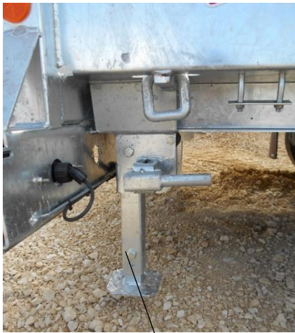
Abstützung hinten unter der Ladefläche (Serie)
