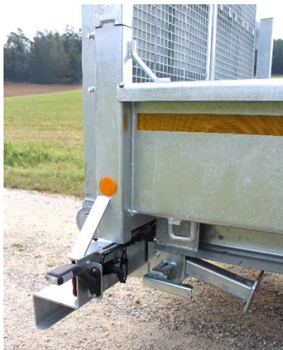
Abstützung hinten unter der Ladefläche (Serie)
