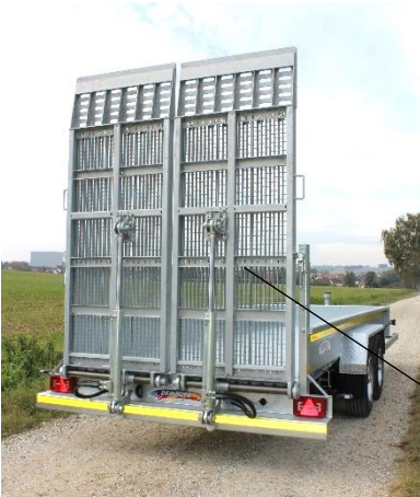
Durchgehende Rampen über die komplette Ladefläche für mechanische oder hydraulische Bedienung
