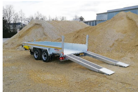
Durchgehende Rampen über die komplette Ladefläche für mechanische oder hydraulische Bedienung
