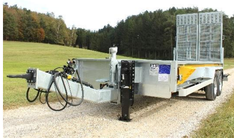
Durchgehende Rampen über die komplette Ladefläche für mechanische oder hydraulische Bedienung
